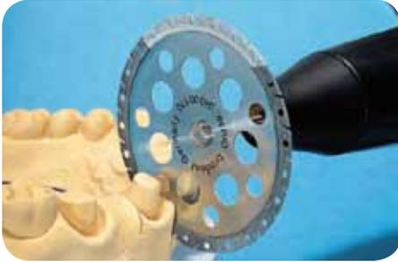
Gifl ex -TR est un disque qui comporte un revêtement de diamant sur les deux côtés et est particulièrement adapté pour couper le plâtre et la résine. Les espaces calculées de dégagement dans le domaine du revêtement de diamant assure l'évacuation rapide de la poussière de meulage et augmente la puissance de coupe du disque. Gifl ex -TR permet une coupe rapide, lisse et fiable, même de plâtre et résine très dur. Les troubles de fracassement et le blocage du disque sont éviter.
